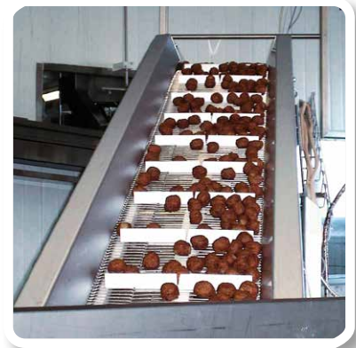
Taśma prętowa pleciona z zabierakami w eksploatacji (transport do góry pulpecików mięsnych)
